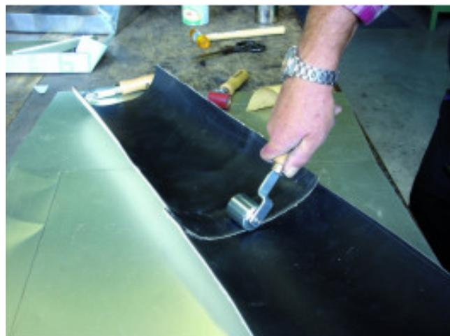
Doppio cuscinetto a sfere. Rulliera in acciaio. Versione pesante. Manico ergonomico in legno. Per saldatura a freddo e per lastre bituminose. Ø 40 mm.
