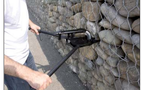
Agrafeuse manuelle spéciale pour la pose d'anneaux GABION
