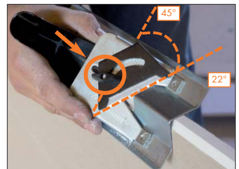
Vis moletée de réglage (angle & profondeur)
