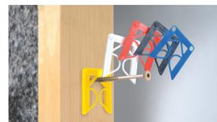
**Les cales crantées** coulissent entre elles pour affiner l'ajustement. Elles sont spécialement utilisées pour la pose de terrasses en bois ou pour créer un joint de dilation lors de la pose de parquet. Elles permettent de corriger les épaisseurs de 12 à 50 mm. Très résistantes et autobloquantes, ces cales peuvent supporter de lourdes charges (200 à 2 200 kg).
